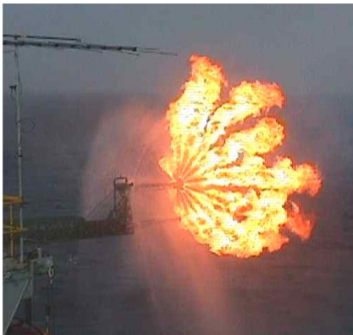
Рисунок 5.1 – Водяной защитный экран факельной горелки
