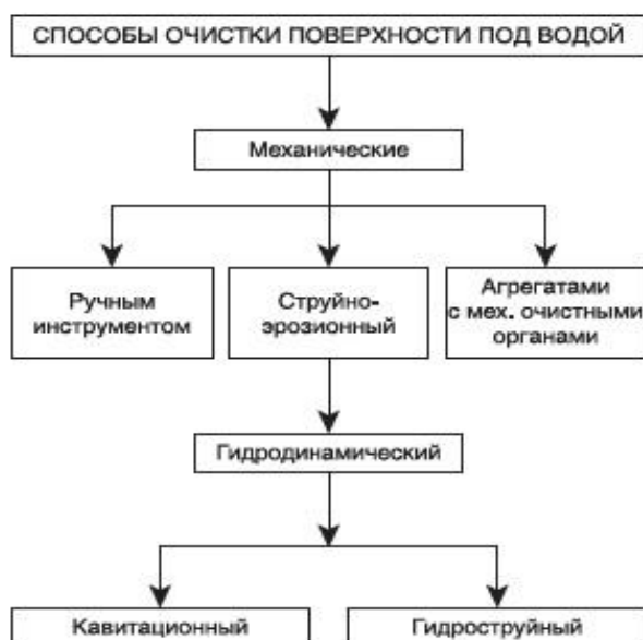
Рисунок 5.2 – Основные механические способы очистки поверхности от обрастания
