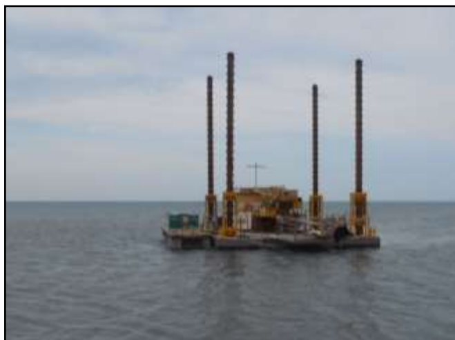
Рисунок 4.5 – Несамостоятельный, самоподъемный буровой понтон «Наука-1» с буровой установкой УРБ-2А2
