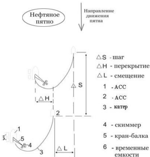
Рисунок 4.2 – Организация мобильного (J - образного) ордера
