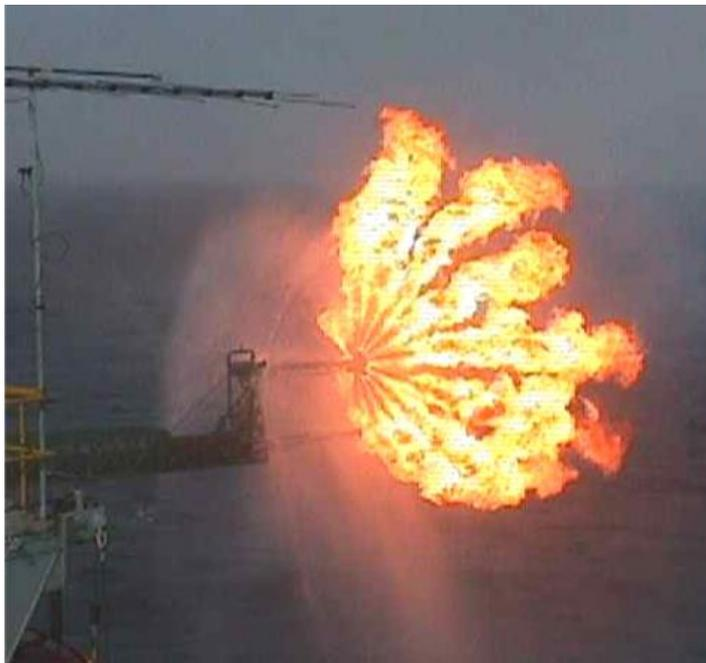
Рисунок 4.1 – Водяной защитный экран факельной горелки
