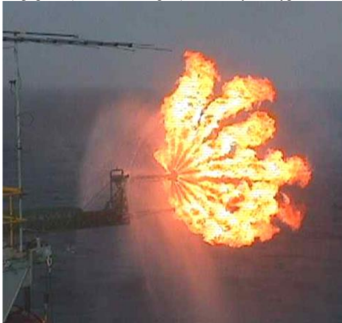
Рисунок 6.3 – Водяной защитный экран факельной горелки
