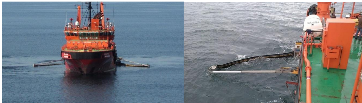
Рисунок 5.1 – Очистка акватории от РН
