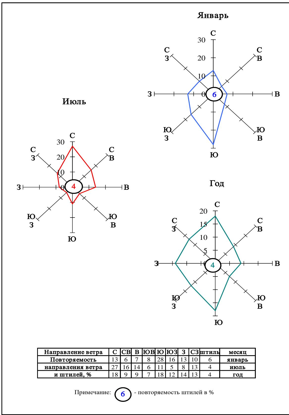
Рисунок 5.1 – Повторяемость направления ветра и штилей (Новый Порт)
