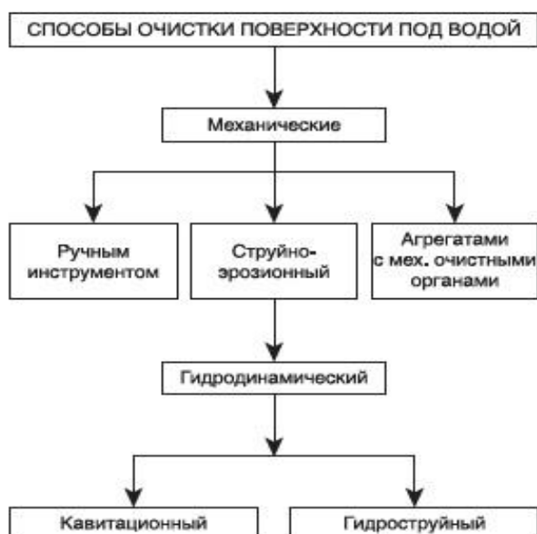
Рисунок 5.2 – Основные механические способы очистки поверхности от обрастания
