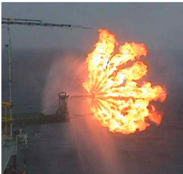
Рисунок 6.1 – Водяной защитный экран факельной горелки
