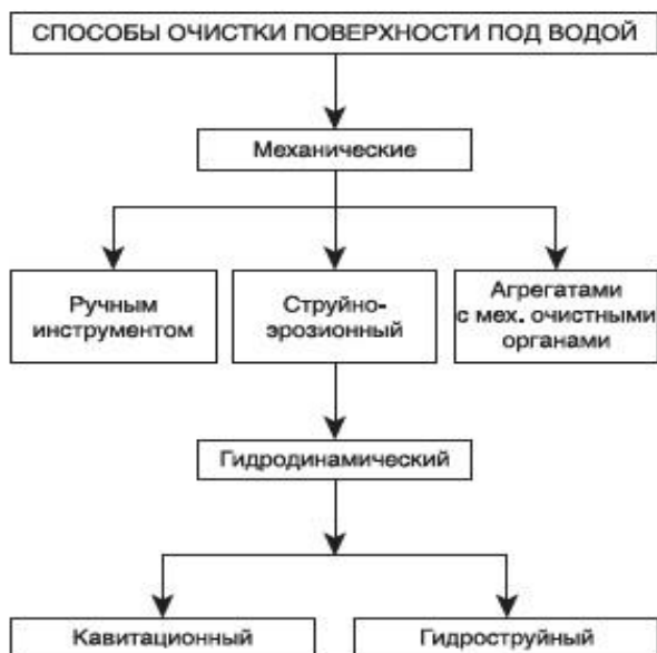
Рисунок 6.2 – Основные механические способы очистки поверхности от обрастания
