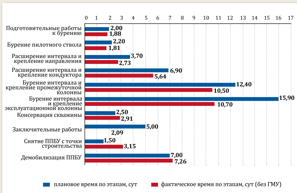
Рис. 5. План-факт по этапам работ при строительстве скв. СК8 Южно-Киринского месторождения
